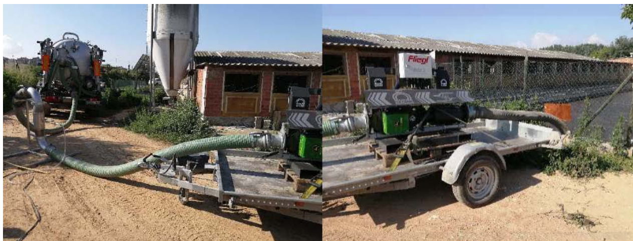
Figura 1. Foto del equipo de toma de muestras conectado a la cisterna y el NIR (izquierda) y del equipo estacionario (derecha)
