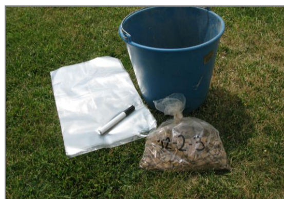
Figura 3. Part del material necessari per a la presa de mostres de sòl (DAAM, 2013)
