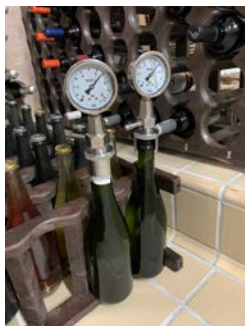
Foto 4. Registre de la cinètica de 2ª FA amb afròmetres. (Font: INCAVI).
