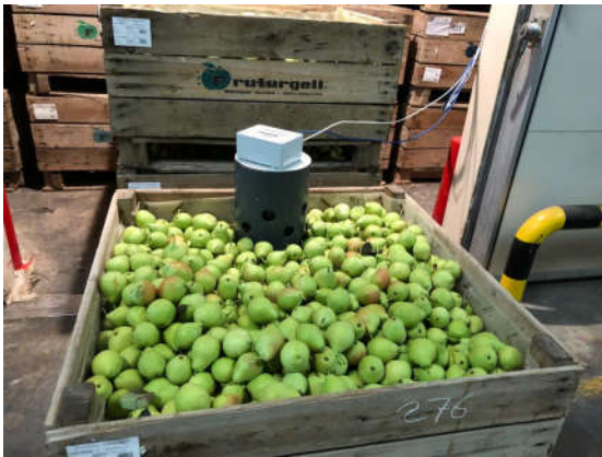
Figura 1: Imatge del sensor dissenyat per l'empresa ILERFRED dipositat en un dels palots de pera Blanquilla abans de l'entrada a la cambra.
