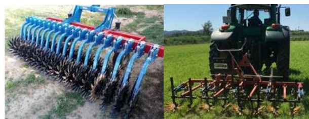
Figura 1. Maquinària pel desherbatge mecànic. Rascle rotatiu d'estrelles (esquerra) i binadora (dreta)
