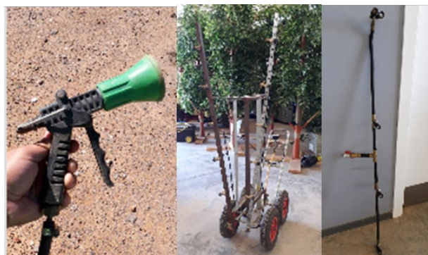
Foto 1. Sistemes d'aplicació utilitzats: a l'esquerra: pistola (Referència); centre: Carretó amb Barra Vertical; Dreta:
