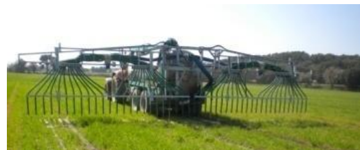
Usar maquinària adequada que permeti aportar dosis baixes i evitar volatilització de N.
