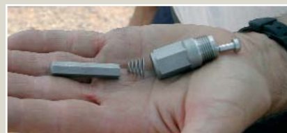
5.- Las piezas sueltas: pulsador, muelle, cuerpo, junta y tornillo, se limpian ó sustituyen. Atención sobre todo al muelle y a la junta.
