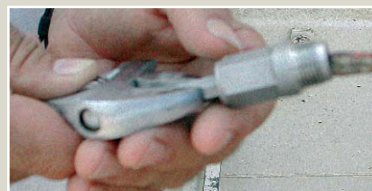
4.- Se suelta el pulsador con ayuda de llave y destornillador.
