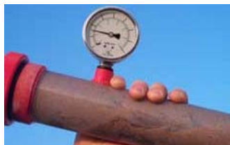
Figura 4. Detall del manòmetre de l'aparell Agrolisier
