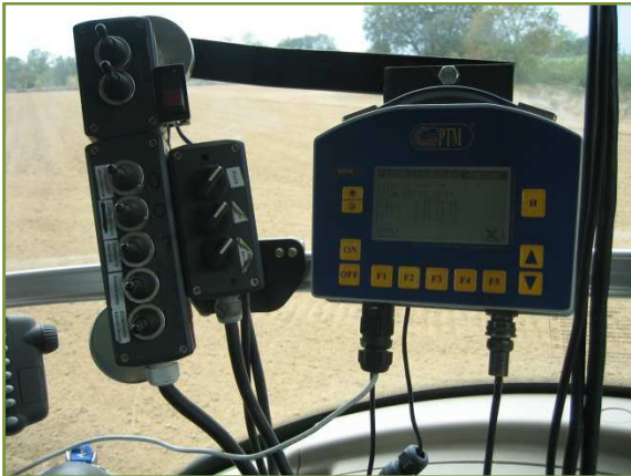
Figura 10. Ús d'un equip conductímetre automàtic. (MillorFer, 2010).
