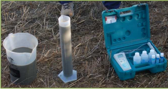
Figura 2. Lectura amb conductímetre de camp (MillorFer, 2010).
