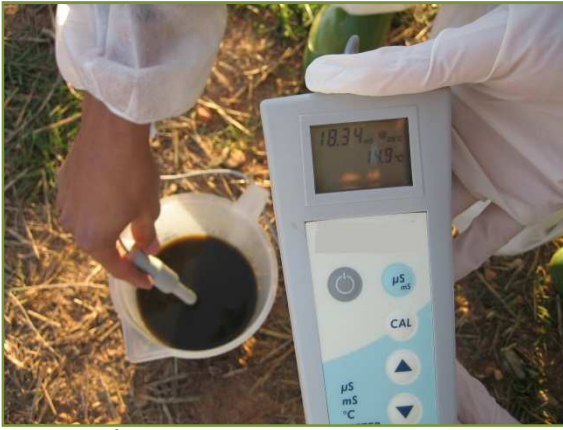
Figura 9. Ús d'un equip conductímetre manual (MillorFer, 2010).
