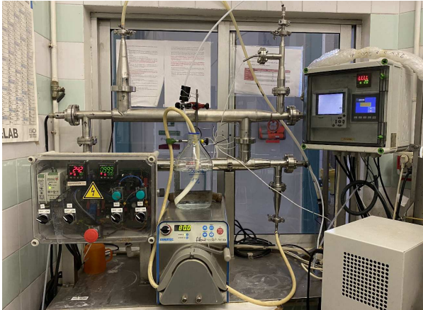
Foto 1. Equip de llum ultraviolada d'ona curta (UV-C) disponible a les instal·lacions de Servei Planta de Tecnologia d'Aliments de la Universitat Autònoma de Barcelona.
