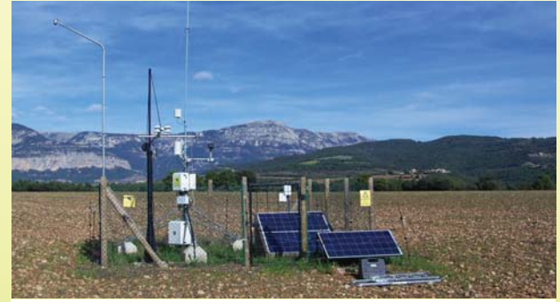
Figura 1. Imatge del camp experimental i de l'equipament de mesura de fluxos turbulents.
