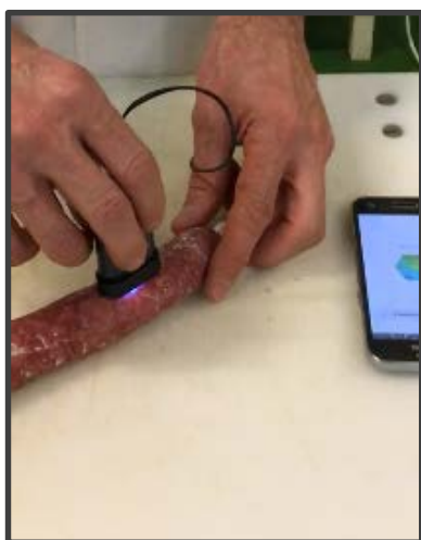
Mostreig NIR a superfície de peça
