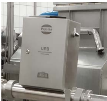
Figura 1. Sensor d'emulsions càrnies instal·lat a la línia de producció de salsitxes Frankfurt, a la sortida de l'homogeneïtzador
