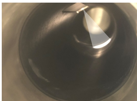
Figura 1. Sensor de emulsiones cárnicas instalado en la línea de producción de salchichas Frankfurt, a la salida del homogeneizador
