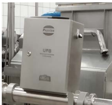
Figura 1. Sensor de emulsiones cárnicas instalado en la línea de producción de salchichas Frankfurt, a la salida del homogeneizador
