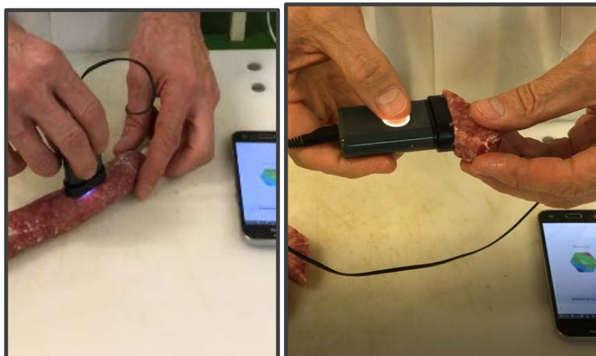
Toma de muestra con NIR en la superficie
