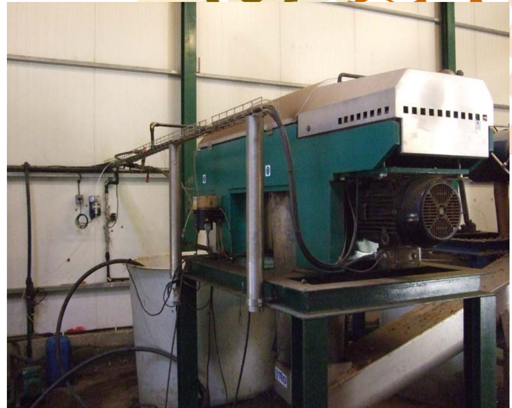
Figura 3.1.3. Imatge de l'esquerra: Sistema de separació sòlid-líquid dels purins mitjançant un tamís de rampa i un cargol premsa. Imatge de la dreta: Equip de separació sòlid-líquid de la fracció líquida dels purins mitjançant centrifugació.
