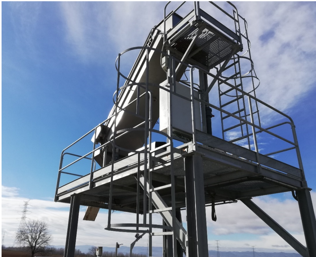
Figura 3.1.3. Imatge de l'esquerra: Sistema de separació sòlid-líquid dels purins mitjançant un tamís de rampa i un cargol premsa. Imatge de la dreta: Equip de separació sòlid-líquid de la fracció líquida dels purins mitjançant centrifugació.
