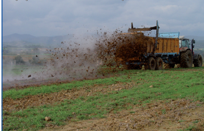
Foto 5. En los distribuidores del estiércol, el fondo móvil del remolque y los rotores del sistema de accionamiento suponen un riesgo que hay que prevenir.
