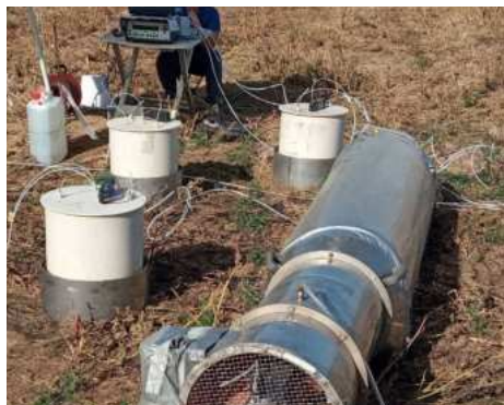
Mesurament in situ de les emissions d'amoníac mitjançant la tècnica de túnel de vent (esquerra) i de les emissions de GEH mitjançant càmera estàtica (dreta)
