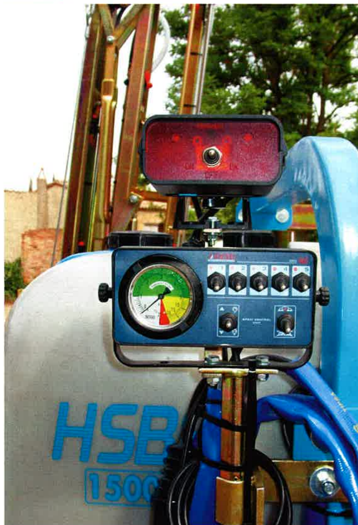
Foto 2 (arriba). Agitación hidráulica del depósito de un pulverizador. Foto 3 (abajo). Sistema electrónico de regulación de un pulverizador.
