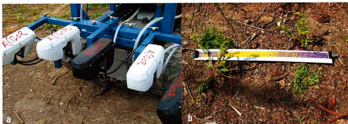
Foto 10. Dispositivo electrónico para la detección de malas hierbas y para la aplicación de herbicidas en tiempo real y visualización sobre papel hidrosensible de una aplicación localizada de herbicida.
