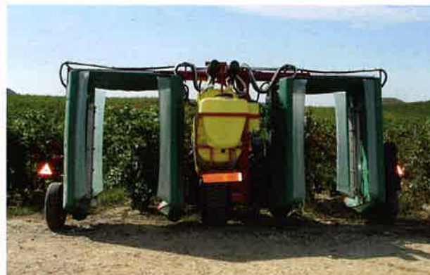
Figura 5. Túnel para los tratamientos a la vid. Foto F. Solanelles
