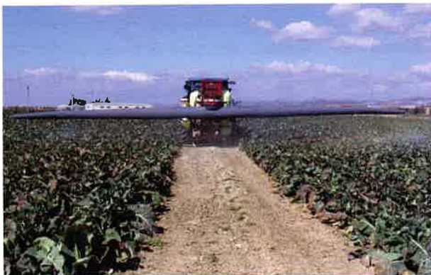
Figura 6. Aplicación con un pulverizador hidráulico con asistencia de aire. Foto A. Fillat
