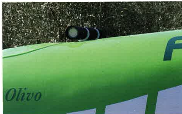
Figura 7. Sensor de ultrasonidos. Foto F. Camp
