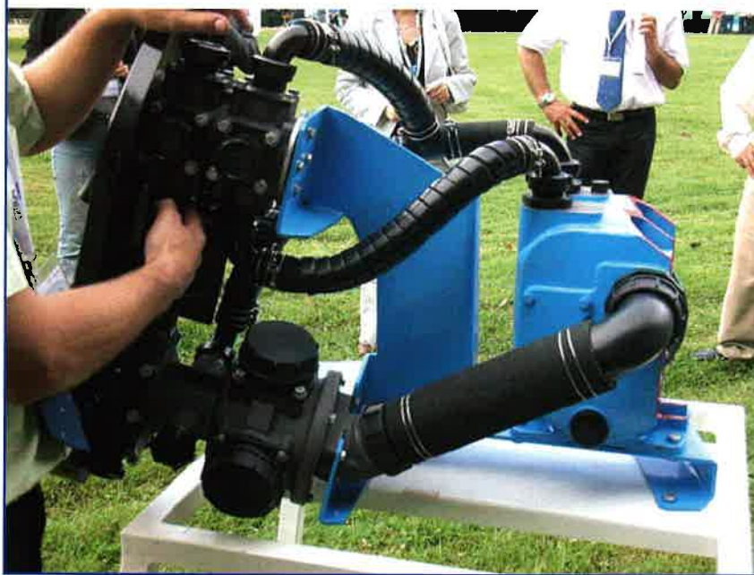
Foto 1. Detalle del sistema de bombeo que permite reducir el volumen residual del depósito del pulverizador. Foto Berthoud.
