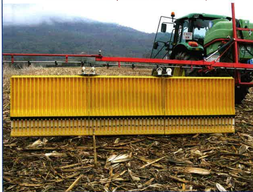
Foto 3. Visualización de la uniformidad de distribución de una barra mediante un banco portátil. Foto Ferran Camp.
