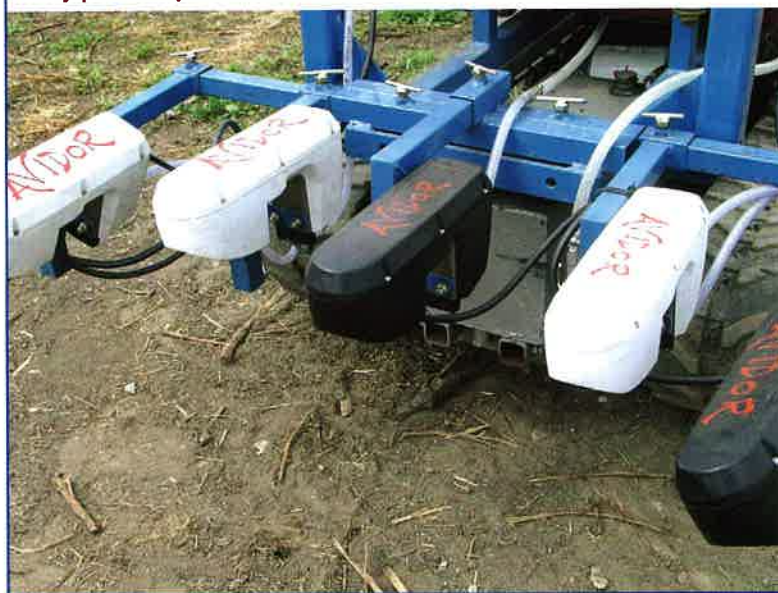
Foto 5. Dispositivo electrónico para la detección de malas hierbas y para la aplicación de herbicidas en tiempo real. Foto CMA.
