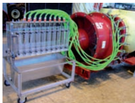
Ensayo del caudal de las boquillas.
