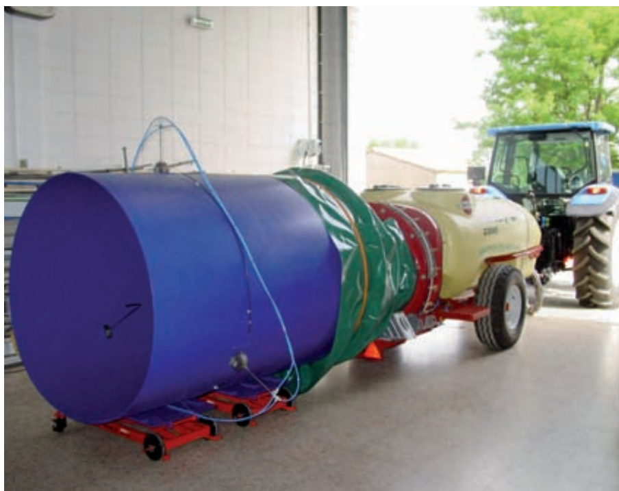
Ensayo del caudal de aire del ventilador.
