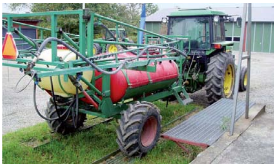
Foto 9. Lugar acondicionado para la preparación y limpieza de la máquina de tratamientos fitosanitarios.
