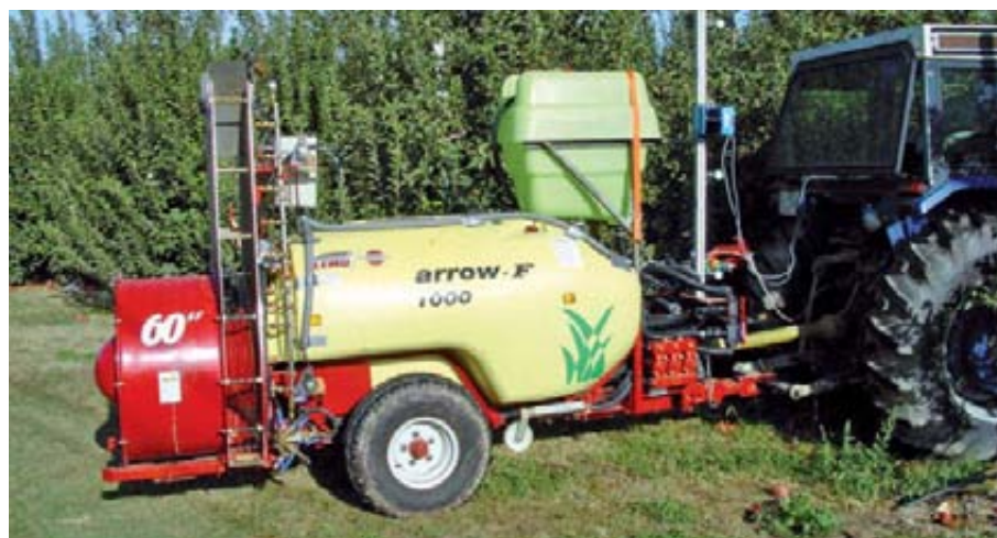
Foto 8. Prototipo de pulverizador del CMA-UdL para la aplicación proporcional de fitosanitarios en frutales.
