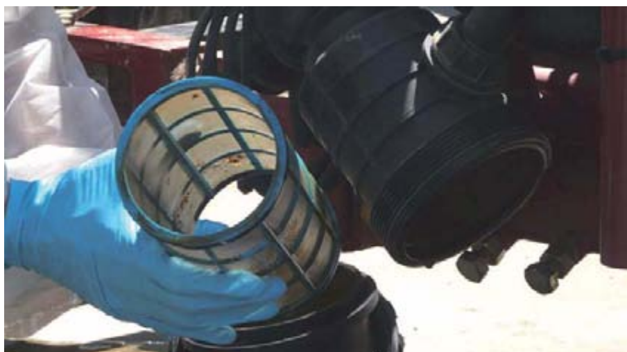
Foto 1. Operaciones de mantenimiento en el sistema de filtrado del equipo de aplicación de fitosanitarios.
