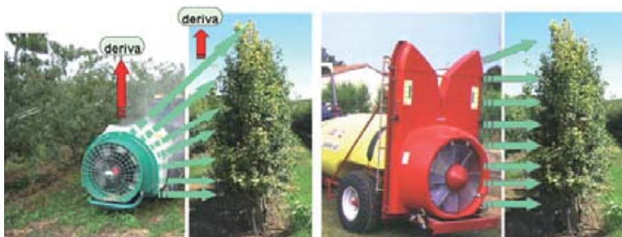
Foto 2. Equipo convencional (izda) con poca adaptación a la geometría del cultivo y equipo con deflectores verticales (dcha) que favorece una distribución más uniforme del producto en el árbol.
