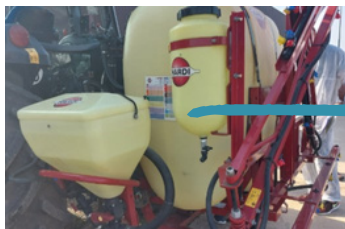
Dipòsit incorporador de fitosanitaris al polvoritzador
