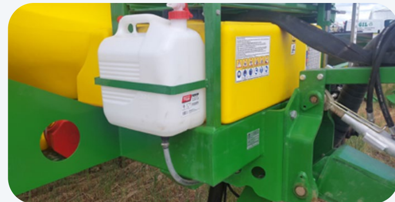
Figura 18. En els polvoritzadors s'instal·larà un dipòsit d'aigua neta (mínim 15 l) per motius de seguretat.
