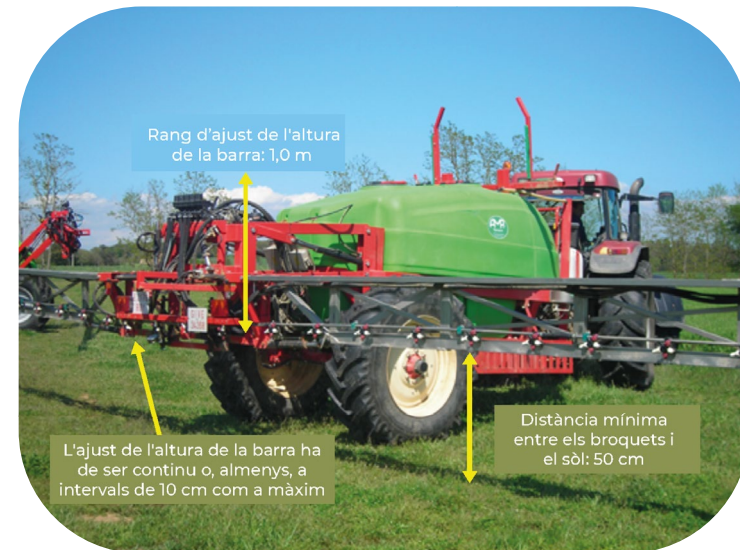
Figura 8. Principals requisits/funcionalitats dels ajustos de la barra del polvoritzador.
