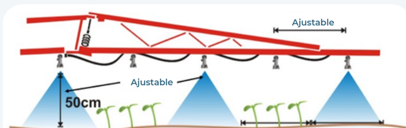
Figura 21. En un polvoritzador per a aplicació en bandes, l'altura dels broquets, la distància entre ells i l'angle de polvorització han de ser paràmetres ajustables.
