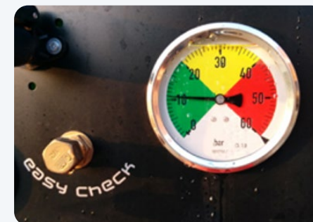
Figura 14. El polvoritzador comptarà amb un dispositiu per connectar fàcilment els instruments utilitzats durant la inspecció obligatòria dels polvoritzadors en ús segons la norma ISO 16122. Esquerra: adaptador de fàcil connexió per comprovar la bomba; dreta: adaptador de fàcil connexió per comprovar el manòmetre.
