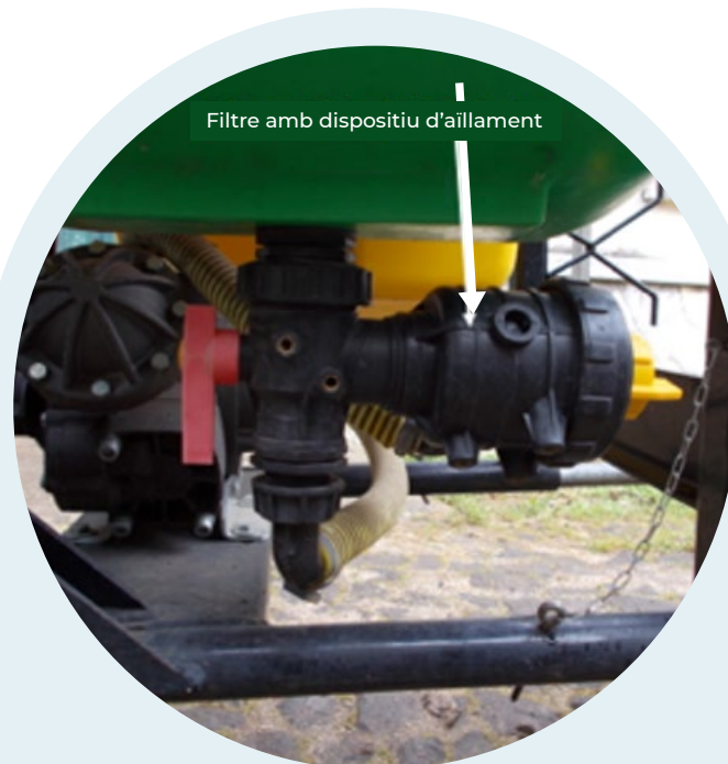
Figura 10. Dispositiu d'aïllament que permet desmuntar el filtre, fins i tot amb el dipòsit ple.
