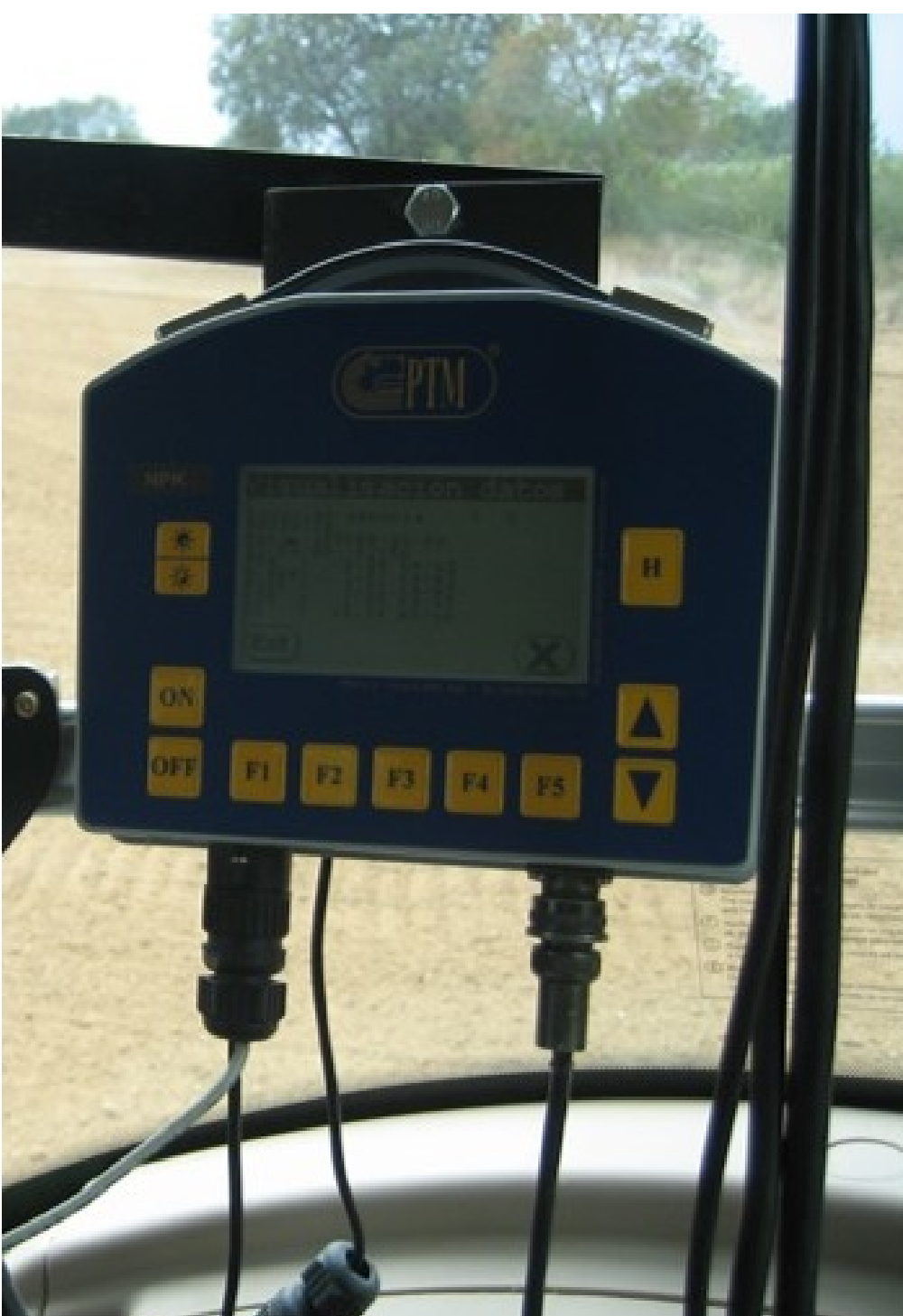
Conductímetre fix a la cisterna
