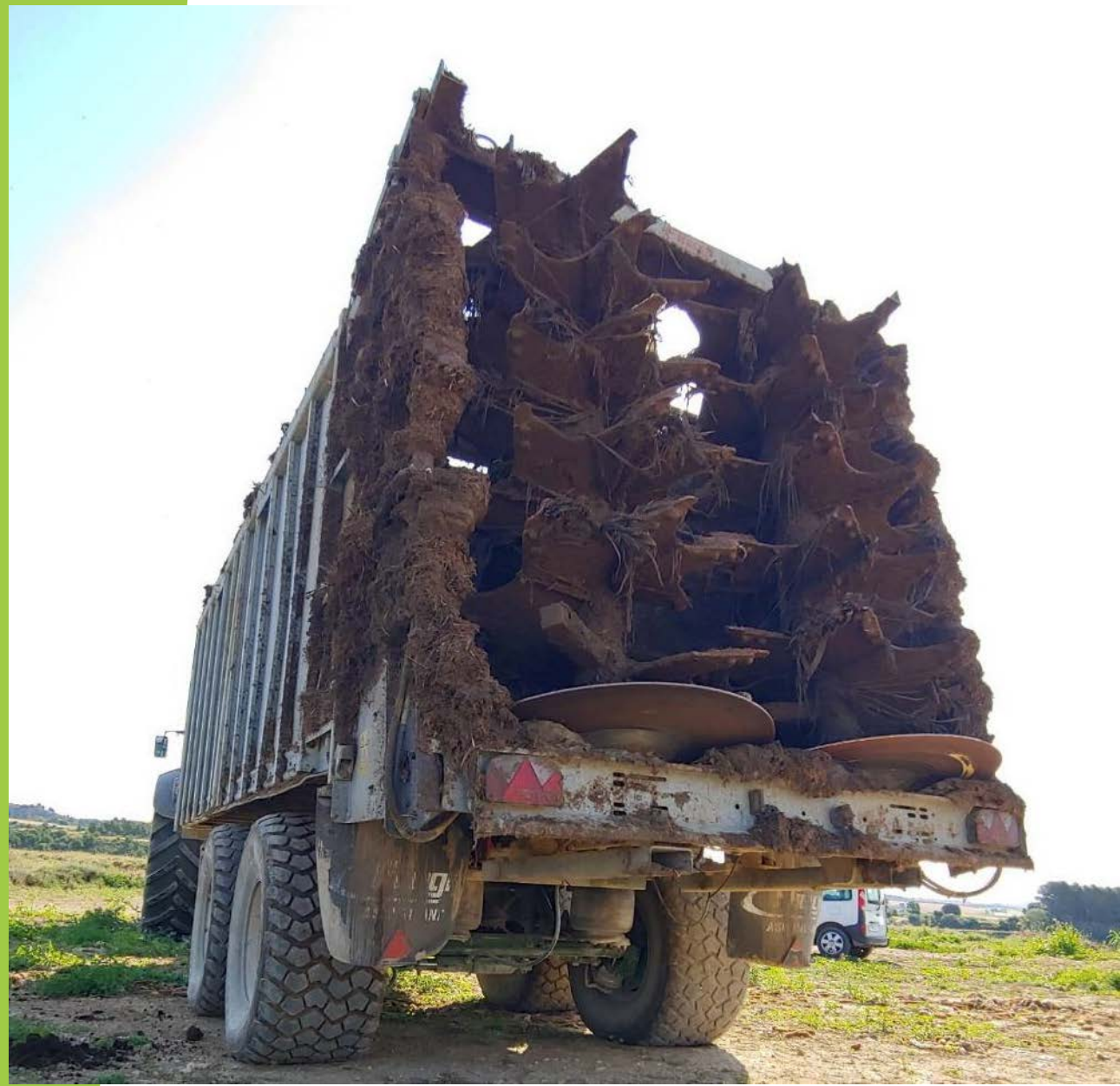
Escampador amb rotor vertical
