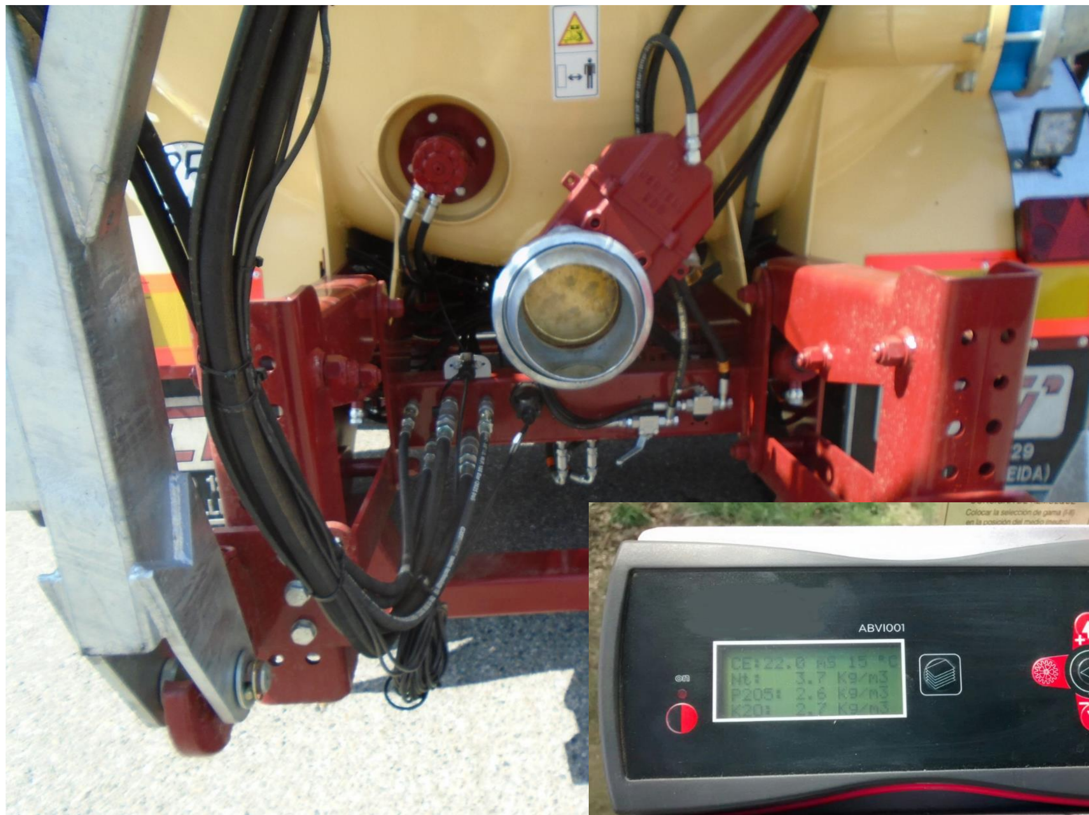
Equip conductímetre fix a la cisterna
