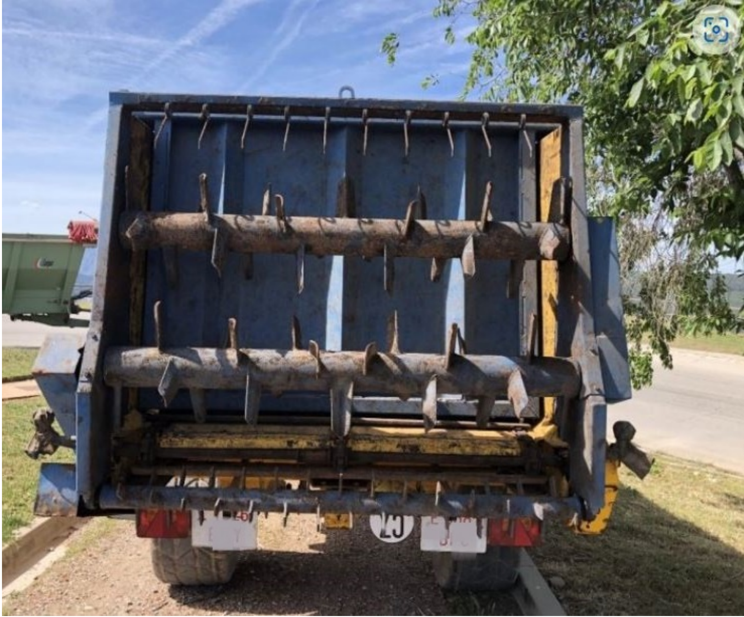
Escampador amb rotor horitzontal
