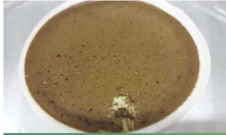
Etapa actual de refinament d'estruvita precipitat ric en estruvita
